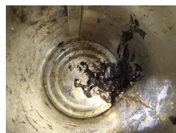
写真 缶詰めに混入したグリス
